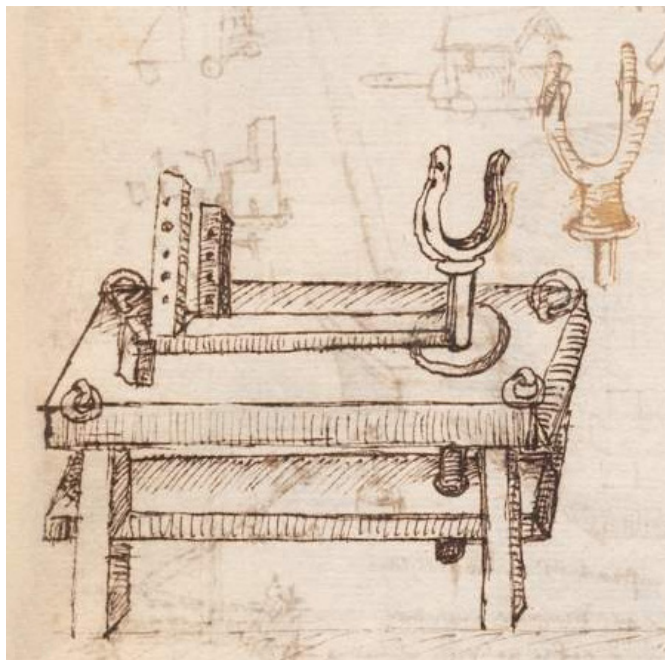
FIG. 6. Un «ceppo» per un'arma di piccolo calibro, dal De ingeneis di Mariano Taccola. Cominciato nel 1419, il trattato del «pratico» senese sarebbe stato portato a termine soltanto nel 1449, raccogliendo centinaia di disegni di macchinari di ogni genere, inclusi i nuovi armamenti.
