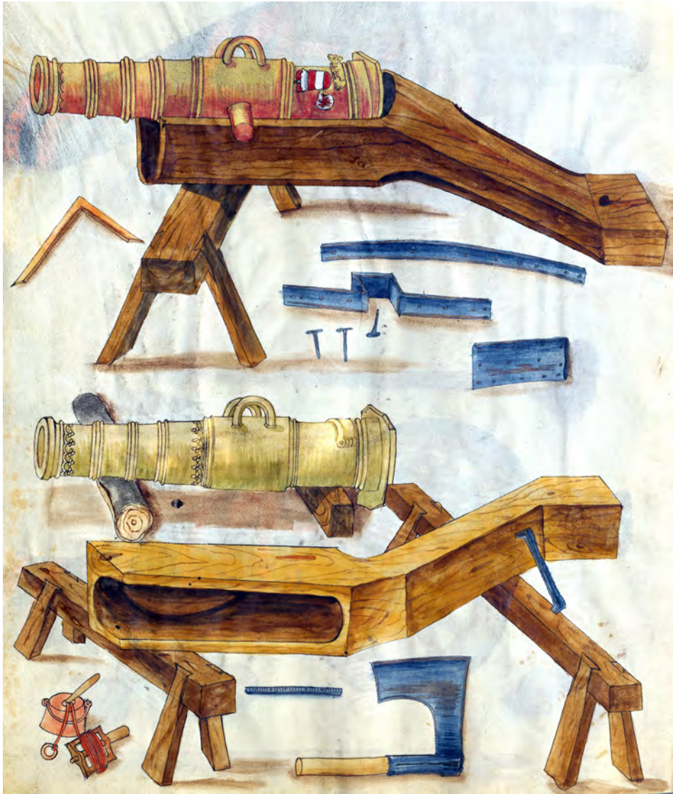
FIG. 8. Di semplice concezione, questi due affusti potevano permettere una facile oscillazione dell'arma grazie all'incavo realizzato nella sezione posteriore. Non altrettanto facile, però, doveva essere il fissaggio della canna all'attrezzo.
