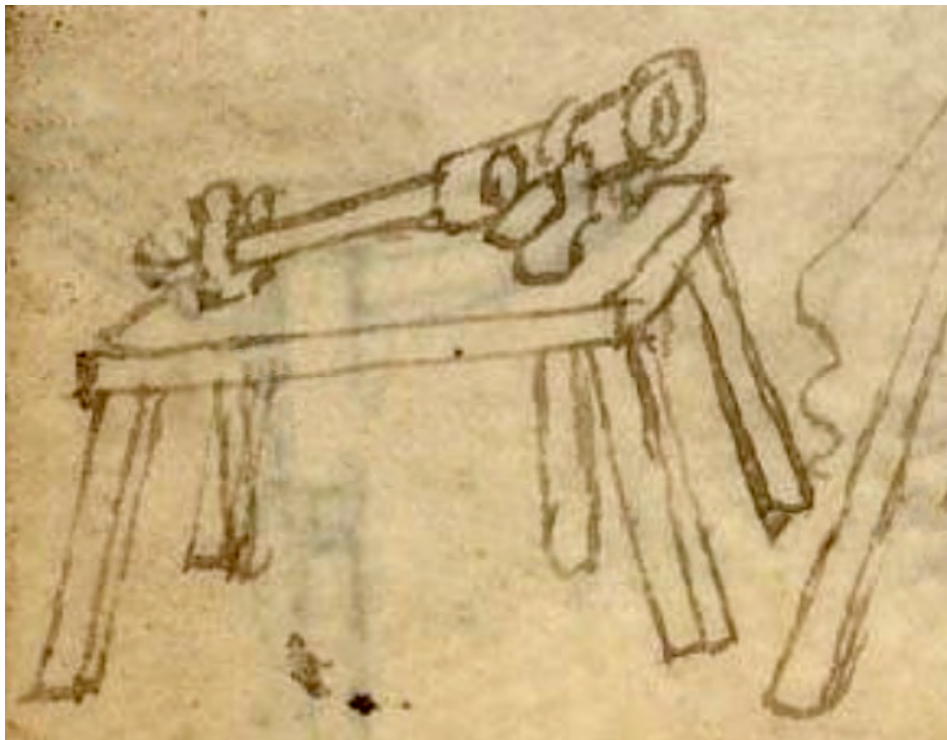
FIG. 10. Montata sul suo «ceppo», questa piccola spingarda era stata pensata da Francesco di Giorgio con due protuberanze cilindriche poste vicino alla bocca del pezzo.
