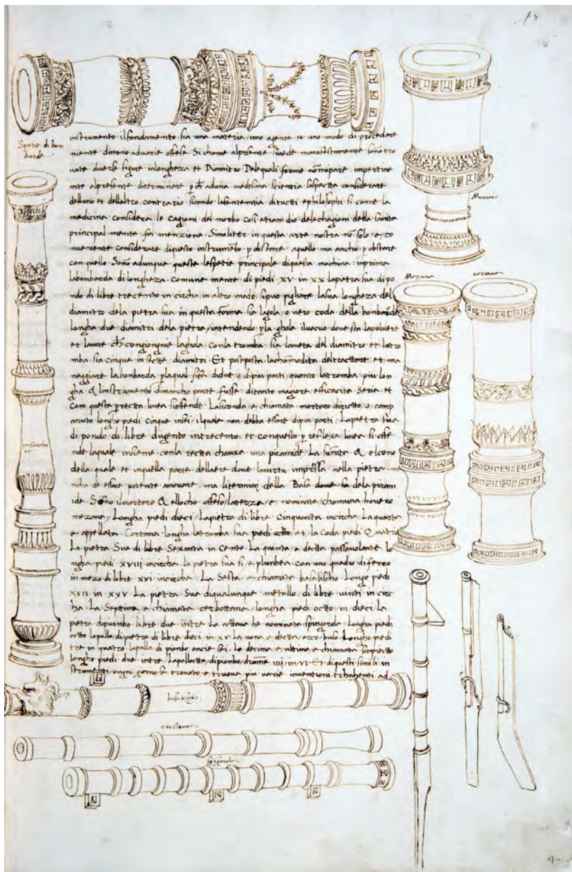
FIG. 24. La famosa pagina del Trattato di architettura martiniano dedicata alla classificazione delle «spetie di bombarde». Tra le «minute» si notano, nella parte inferiore del foglio, un «balsalischio», una «cerbottana» e una «spingarda», mentre una lunga «passavolante» chiude, invece, il margine sinistro della carta.
