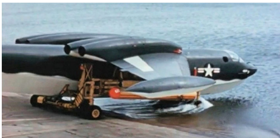
Fig. 24) Il momento dell'ingresso in acqua del primo Seamaster di serie. Sono evidenti gli scarichi appaiati dei reattori Pratt and Whitney J-75P-2 privi di postbruciatore. Fermo immagine da un filmato realizzato dalla Martin. https://archive.org/details/82334YP6MFootageR2MosVwr .
