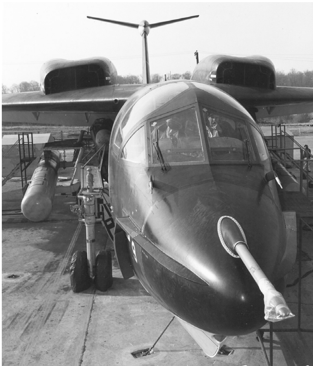
Fig. 25) Vista frontale del P6M-2 No 9 posizionato sul BV; in evidenza la sonda per il rifornimento in volo, il nuovo canopy (tettuccio) e, ai lati del muso, un nuovo tipo di flap ripiegabile sperimentato per tentare di ridurre il fenomeno della quantità eccessiva di spruzzi creata in determinate condizioni del moto ondoso. GMMAM via via American Aircraft Fan Club, cit.
