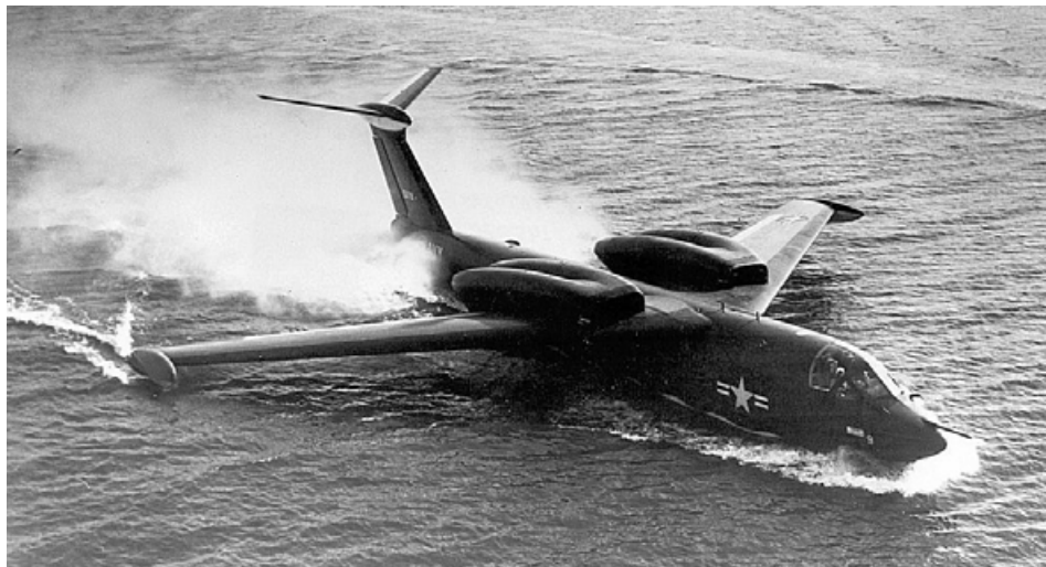
Fig. 23) Il primo esemplare di P6M-2 (ship n° 9, BuAer No 145878) in flottaggio lungo il Patuxent River nel 1959; in evidenza la nuova forma delle carenature dei reattori e il nuovo tettuccio della cabina di pilotaggio che se da una parte garantiva una eccellente visibilità dall'altra nelle giornate soleggiate trasformava l'abitacolo in una serra. L'abolizione del diedro negativo delle ali portava a problemi di instabilità trasversale, evidenziati nella fotografia dal fatto che il galleggiante destro sfiora l'acqua mentre quello sinistro è sollevato. US Navy via San Diego Air and Space Museum (SDASM).
