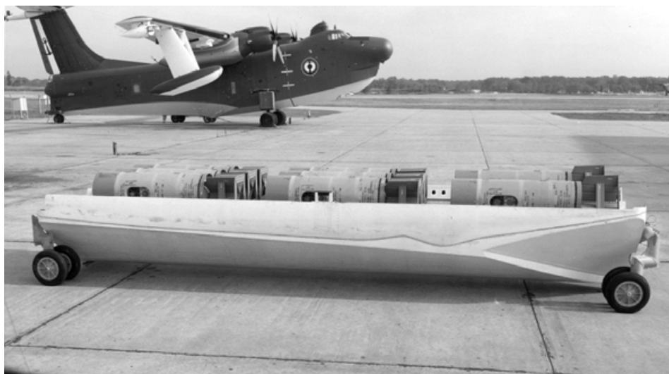
Fig. 9) Il portello rotante del Seamaster con mine tipo Mk-36 pronto per essere montato sul velivolo tramite i due paranchi elettrici posti sulle paratie trasversali della stiva bombe. Sullo sfondo uno dei Martin P5M-2 costruiti per la Marina francese. GMMAM via Stan PIET.
