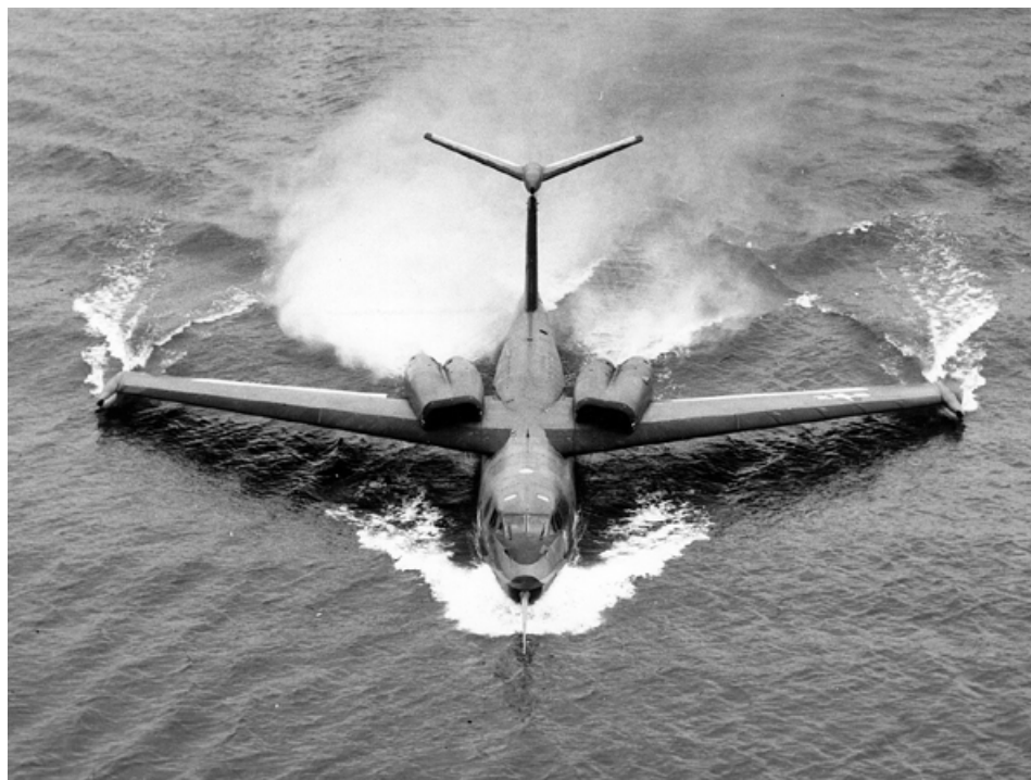
Fig. 20) Vista dall'alto del primo esemplare di preserie dell'YP6M-1 dalla quale si rileva l'inclinazione laterale dei reattori. GMMAM via American Aircraft Fan Club, cit.
