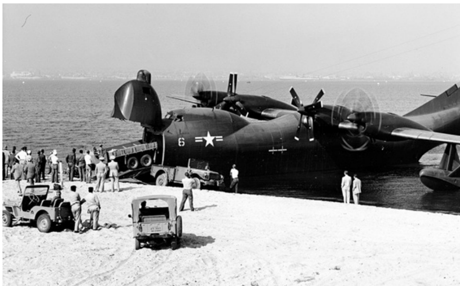
Fig. 29) Un Convair R3Y-2 impegnato a dimostrare di meritare il soprannome di “LST (Landing Ship Tank) volante” in un test di sbarco di automezzi su una spiaggia per mezzo della sua rampa snodata; il velivolo veniva mantenuto in posizione tramite i motori, una operazione che si rivelò abbastanza difficoltosa. Il programma Tradewind fu sospeso dopo che erano stati realizzati solamente tredici esemplari. San Diego Air and Space Museum.
