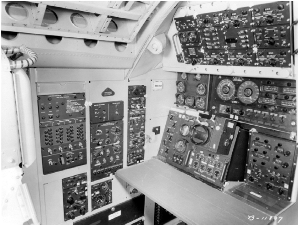
Fig. 21) I pannelli della suite elettronica AN/ASQ-29 (XN-1) nella postazione del navigatore/bombardiere a bordo di un YP6M-1. GMMAM via Stan PIET.
