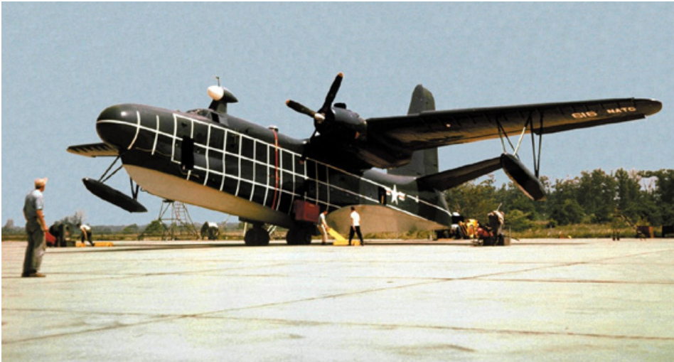
Fig. 5) Il Martin M-270 ottenuto modificando il prototipo XP5M-1 del Martin Marlin. GMMAM via American Aircraft Fan Club, cit.
