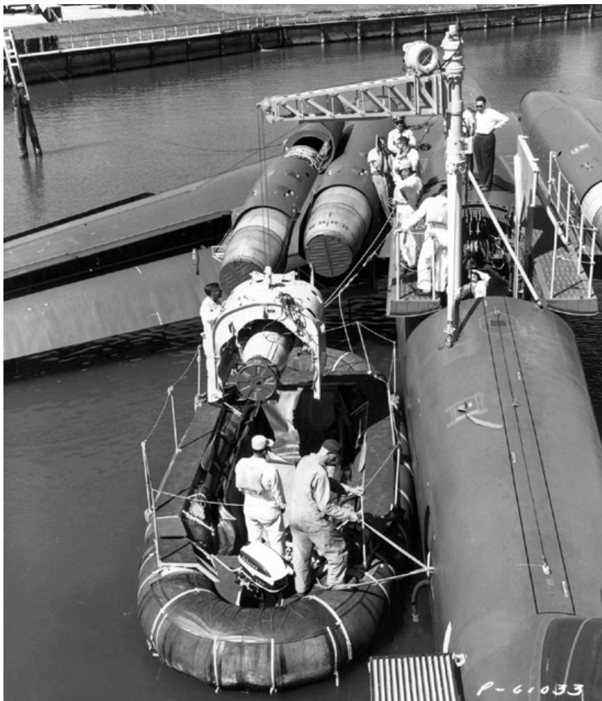
Fig.11) L'imbarco dell'armamento di caduta tramite i portelloni dorsali con il velivolo in acqua era un processo lento che richiedeva acque molto calme. I due portelloni aperti fungevano anche da piattaforme di lavoro. Nella foto la gru smontabile sta issando a bordo una mina fissata alla slitta che una volta all'interno della fusoliera porterà l'ordigno nella stiva bombe. GMMAM via Stan PIET.
