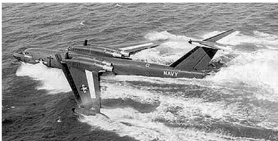
Fig. 17 Un'immagine purtroppo di scarsa qualità del secondo prototipo in flottaggio ad alta velocità; si notano le prese d'aria ausiliarie poste sopra le carenature dei reattori aperte per sopperire ad eventuali ingestioni d'acqua dalle prese d'aria principali. Queste prese d'aria verranno poi eliminate negli esemplari di preserie. Fonte Wikipedia.
