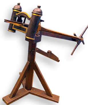
L'“Erzspanngeschütz” dell'ingegnere tedesco Erwin Schramm (1856-1935): ricostruzione ipotetica del χαλκοτόνον (Chalkotonon. pezzo di artiglieria con molla di bronzo) di Filone Alessandrino. Vetrina con ricostruzioni di pezzi di artiglieria meccanica nel Museo del Castello di Saalburg in Assia (Germania). Particolare dalla Foto di SBA73 2007, su Flickr (Artilleria experimental romana a Saalburg). CC SA 2.0, Wikipedia Commons.
